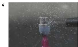
Die Klebefläche der Ti-Basis mit Strahlmittel  $Al_2O_3$  50-100 µm bei max. 2 bar Druck und 1-2 cm Distanz zur Strahldüse abstrahlen bis eine matte Klebefläche erreicht ist.
