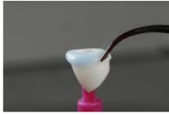
Die Mesostruktur zur einfacheren Handhabung vor dem Strahlen auf einem Träger fixieren (z.B. Microbrush).
