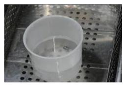
Reinigen der Ti-Basis mit Dampfstrahler oder im Ultraschallbad (Ethanolbad). Danach die Klebefläche nicht mehr mit den Händen berühren, da die Oberfläche fettfrei bleiben muss.
