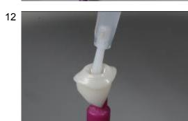
Monobond Plus mit einem Pinsel oder Microbrush auf die vorbehandelte (gestrahlte) Fläche der Mesostruktur auftragen, 60 Sekunden einwirken lassen und anschließend mit starkem Luftstrom verblasen.
