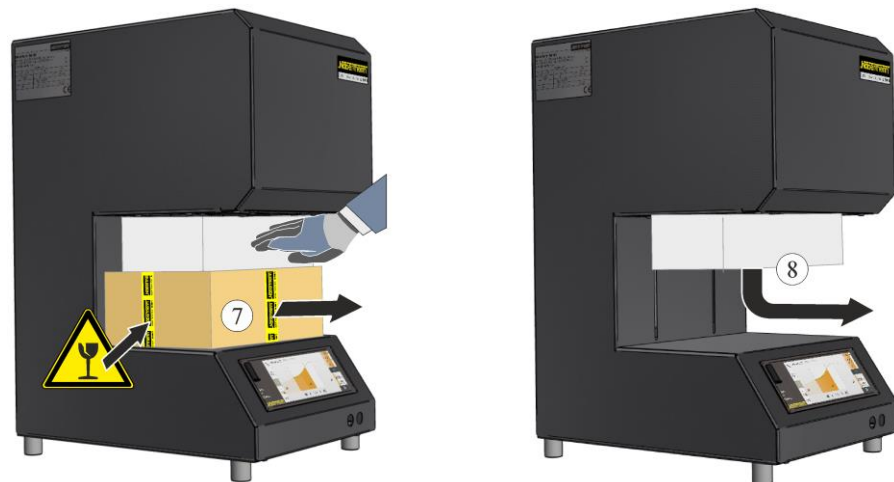
Fig. 10 : Retirer avec précaution les fixations de transport de la chambre du four (figure similaire)
