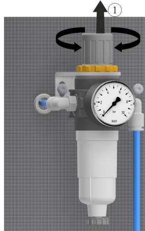
Fig.12 : Réglage de pression sur l'unité de maintenance d'air comprimé (figure similaire)
