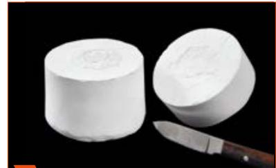
**3** Fendre le cylindre à l'aide d'un couteau placé dans la zone de rupture.
