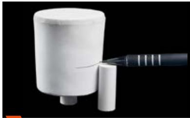
**1** Avec un deuxième piston de pressée, déterminer la profondeur de pressée par marquage.
