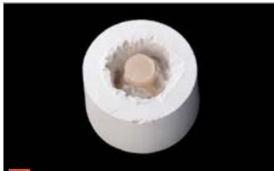
**4** Démouler grossièrement à l' $\text{Al}_2\text{O}_3$  (grain de  $50\ \mu\text{m}$ ) à une pression de 4 bars.
