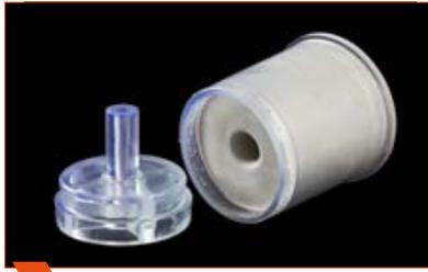
**1** Retirer le socle du cylindre d'un mouvement rotatif.
