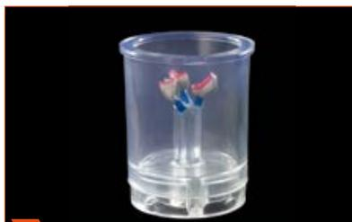
**1** Avant la mise en revêtement, vérifier le poids de cire et la mise en place des tiges.
