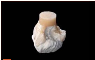
**5** Démouler finement et éliminer la couche de réaction sous 2 bars de pression.
