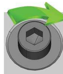
ABB. 35 – DIE SCHRAUBE AN DER GEWÜNSCHTEN POSITION LÖSEN
