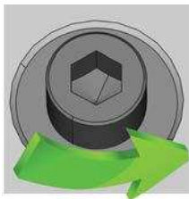
ABB. 37 – SCHRAUBE FESTSCHRAUBEN, UM DEN BLOCK ZU FIXIEREN
