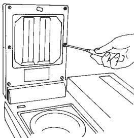
Laite kytetään päältä pois ja verkkopistoke vedetään irti!
