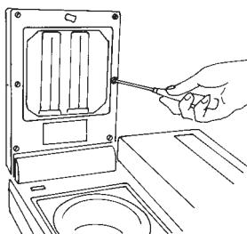
Hvis reflektoren bag rørene er snævet, skal denne ligeledes rengøres med en klud, der er fugtet med sprit.
