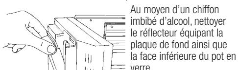
Au moyen d'un chiffon imbibé d'alcool, nettoyer le réflecteur équipant la plaque de fond ainsi que la face inférieure du pot en verre.
