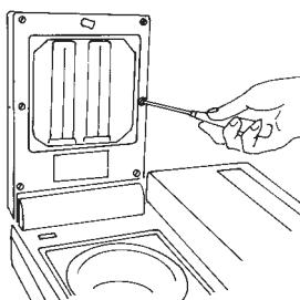
Accionando-se a tecla da tampa, a câmara de polimerização abre-se! Desligar o aparelho e retirar a ficha de rede! Desaparafusar os seis parafusos da placa de cobertura e retirar a placa de cobertura juntamente com o vidro.
