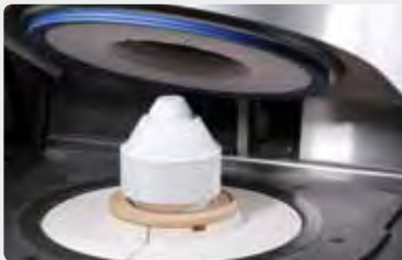
Heisse und bestückte Muffel mit der Muffelzange im Zentrum des heissen Pressofens platzieren.
