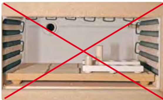
IPS InLine PoM Rohling und IPS Einwegkolben Kolben 300 g / Alox Kolben nicht vorwärmen.
