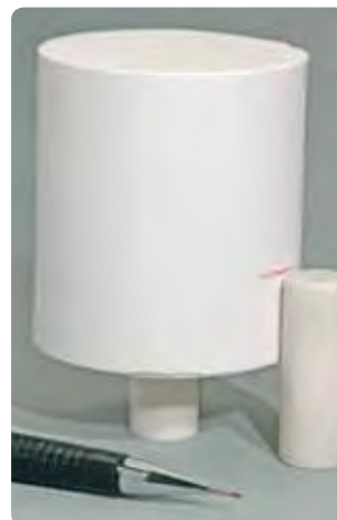
Länge des Alox-Kolbens markieren.
