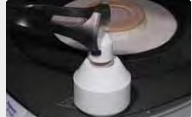
Kalten IPS Einwegkolben 300 g in die heisse Muffel geben.
