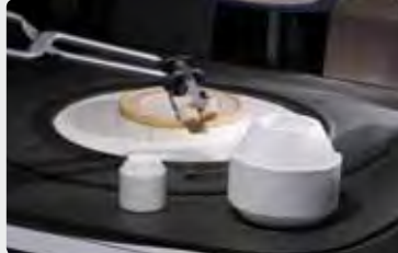
Kalten IPS InLine PoM Rohling mit dem Aufdruck nach oben in die heisse Muffel geben.
