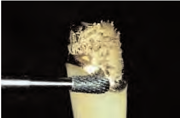
Ausarbeiten der aufgespastes Metallgerüste.
